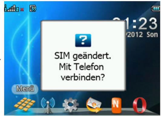
Wenn das eingegebene **Telefonkennwort falsch** ist, wird sich das Telefon normal einschalten und der „neue Benutzer“ wird alle Funktionen zur Verfügung haben **außer** das Menü „**Verlustkontrolle**“. Gleichzeitig sendet das Telefon auf heimlicher Weise einen Hinweis-SMS an alle Vertrauten Nummern mit jeder fremden SIM Karte. Die SMS enthält das Telefon-IMEI und die Telefonnummer/n des neuen Benutzers.
