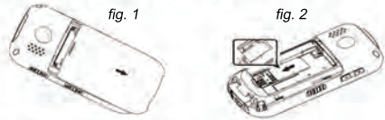
Fig. 1: Rimuovere il copri batteria (come mostrato). Fig. 2: Far scorrere la SIM card con la parte dei contatti rivolta verso il basso.
