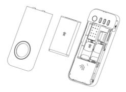
Nota: Installare la batteria come mostrato nel diagramma per evitare che la placca di contatto della batteria venga danneggiata.
