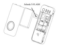
Installazione della scheda T-FLASH: aprire il coperchio posteriore ed estrarre la batteria, liberare il bloccaggio della scheda T-Flash, inserire la scheda T-Flash nel proprio alloggiamento, riboccare la scheda e reinserire la batteria prima di riaccendere il telefono.
